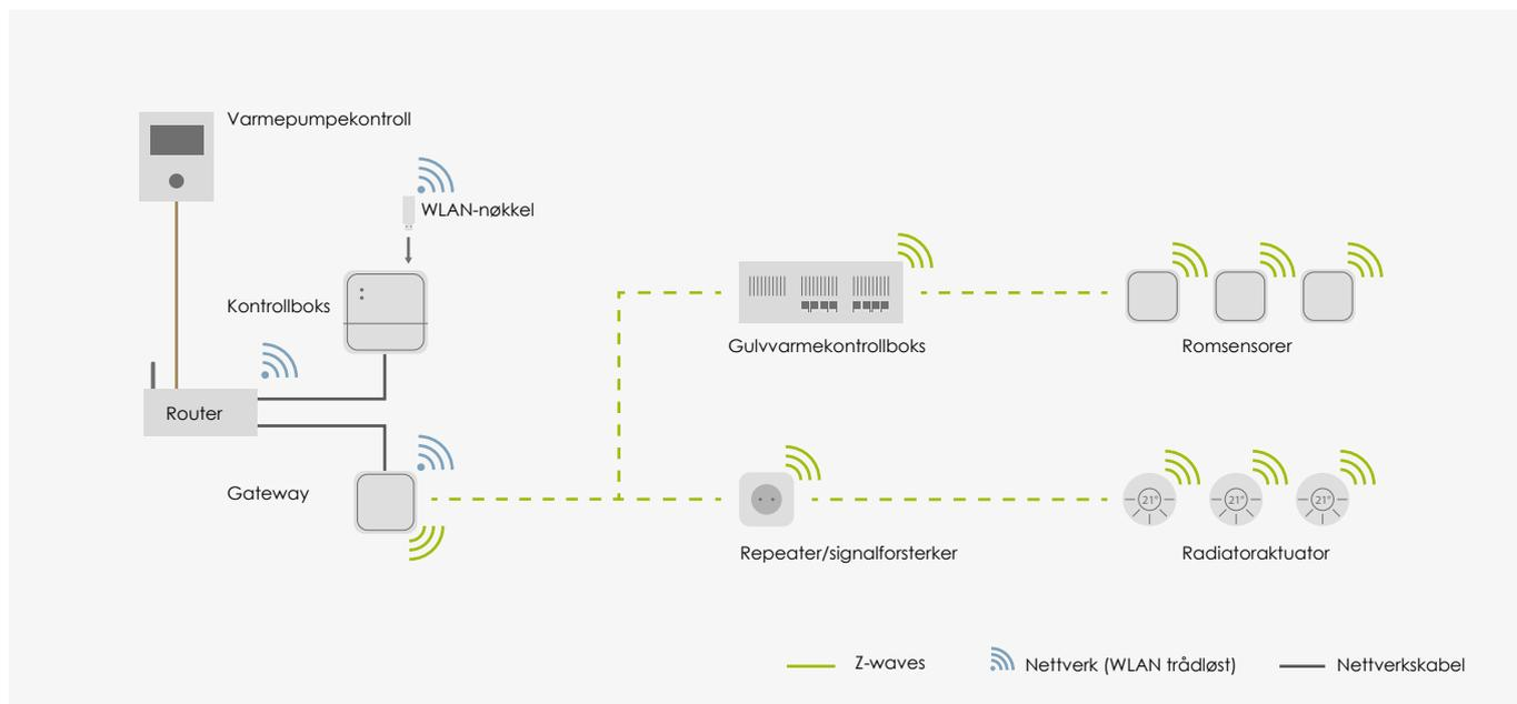
Kommunikasjon kan etableres mellom gatewayen og radiatorstasjoner / gulvvarmekontrollsystem via et trådløst nettverk ved å trykke på tilkoblingsknappen.
